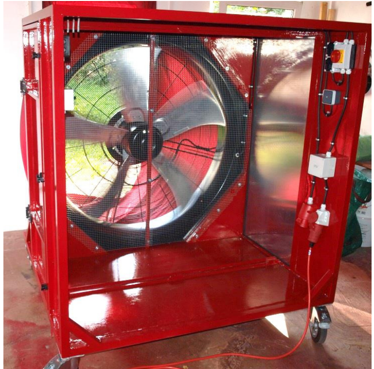
Messsystem EC-LME, Luftleistung bis 60.000 m 3 /h, entspricht etwa 8 BlowerDoor-Ventilatoren.
