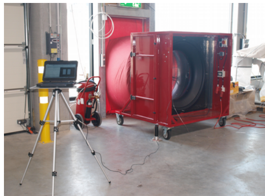
Abbildung 2: Unser fahrbarer Messeinrichtung EC-LME mit Großventilator an der Türe einer Halle
