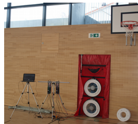
Abbildung 1: Messaufbau BlowerDoor MultipleFan mit 2 tragbaren BlowerDoor-Ventilatoren in der Türe einer Sporthalle
