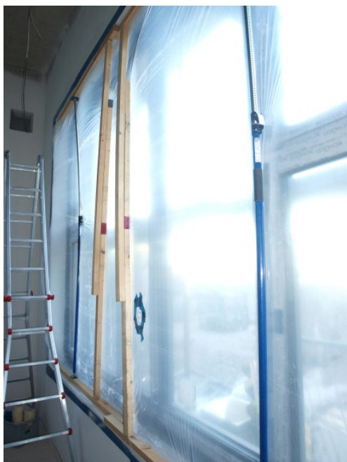
Messung der Fugendurchlässigkeit eines Fensterelementes ca. 4 m x 3 m auf der Baustelle, Prüfung sowohl der Einbaufugen als auch der Funktionsfugen zusammen.
