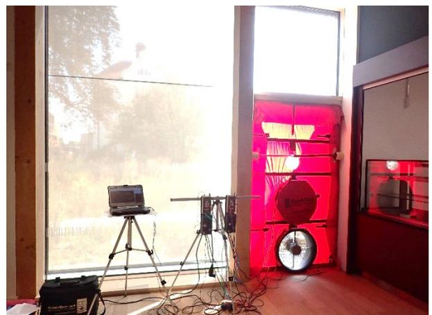
**Eingesetztes Messsystem:** BlowerDoor MultipleFan, 2 Ventilatoren
