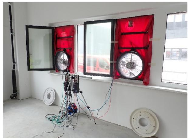
**Eingesetztes Messsystem:** EC-LME (bis 40.000 m<sup>3</sup>/h) und 2 BlowerDoor-Ventilatoren.
