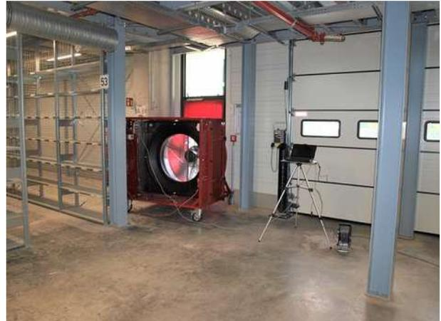
*Luftdichtheitsprüfung einer Logistikhalle bei München mit unserem Großventilator EC-LME und zusätzlichen 2 BlowerDoor-Ventilatoren (hier nicht im Bild)*
