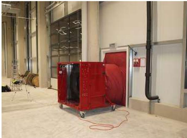
*Luftdichtheitsprüfung einer Produktionshalle mit Büroanbau in Nürnberg mit unserem Großventilator EC-LME*
