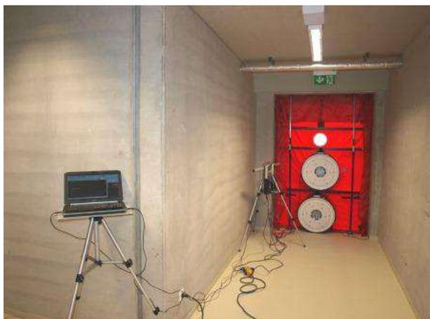
*Luftdichtheitsprüfung einer Mehrfeld-Sporthalle in Coburg mit der BlowerDoor MultipleFan, 2 Ventilatoren*
