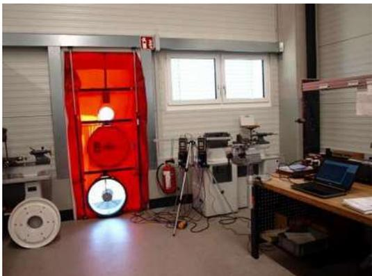
*Blower-Door-Test an einer bereits in Nutzung befindlichen Produktionshalle an einem Samstag.*
